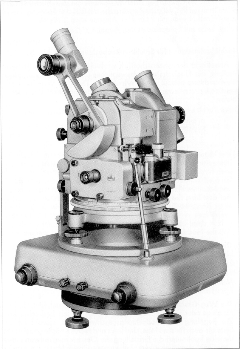
Bild 8. Präzisionstheodolit nach Gigas mit Nachführeinrichtung für Satellitenbeobachtung, Ableseseite
