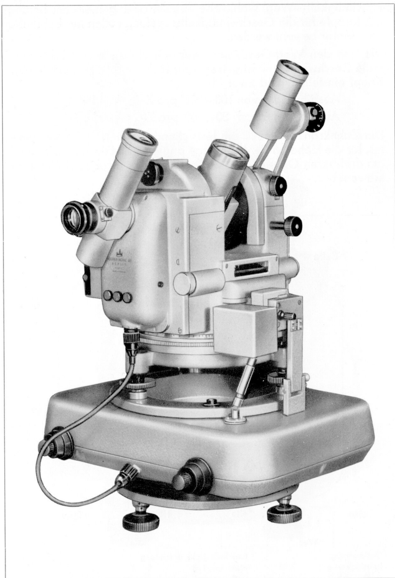
Bild 10. Präzisionstheodolit nach Gigas mit Nachführeinrichtung für Satellitenbeobachtung, Höhenkreisseite
