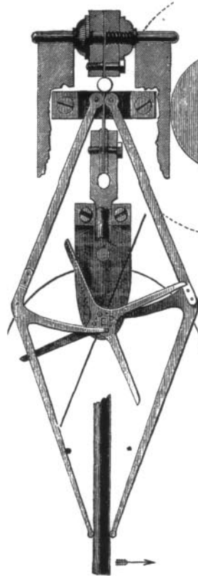
Fig. 13 - Il terzo scappamento applicato da Denison all'orologio di Westminster. E' uno scappamento a gravità a "quattro gambe".
