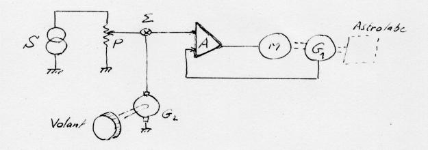
Une source S fournit une tension très stable à un potentiomètre P qui dose la tension fournie à l'amplificateur A. Celui-ci commande le moteur M accouplé à la génératrice tachymétrique G, délivrant une tension proportionnelle à sa vitesse, tension contre-réactionnant l'amplificateur A. Une deuxième génératrice G 2 entraînée par un volant peut alimenter l'amplificateur grâce au circuit sommateur £.
