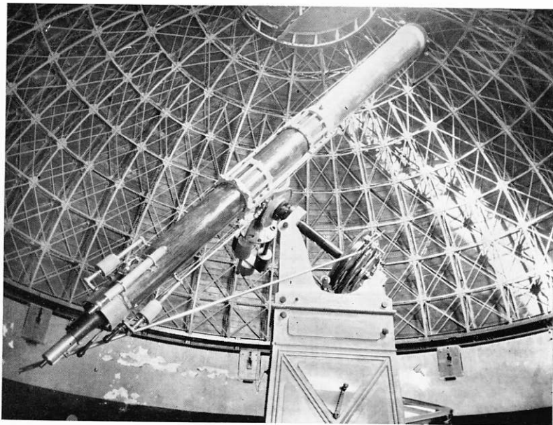
L'EQUATORIALE VISUALE DI MERZ. (Apertura 32,6 cm)
