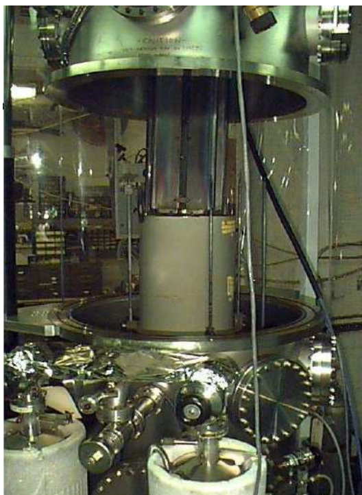
Figura 3.17: La facility di DC magnetron sputtering installata presso il CfA ed utilizzata per la deposizione dei multilayer all'interno delle shell precedentemente prodotte per replica. È possibile vedere una di queste shell con inserita nella parte interna la sorgente di sputtering.
