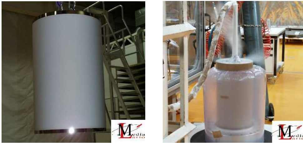
Figura 2.20: (sinistra) Un mandrino dopo il bagno elettrolitico. (destra) Separazione tra mandrino e specchio che avviene per raffreddamento. (Crediti: Media Lario Techn.)
