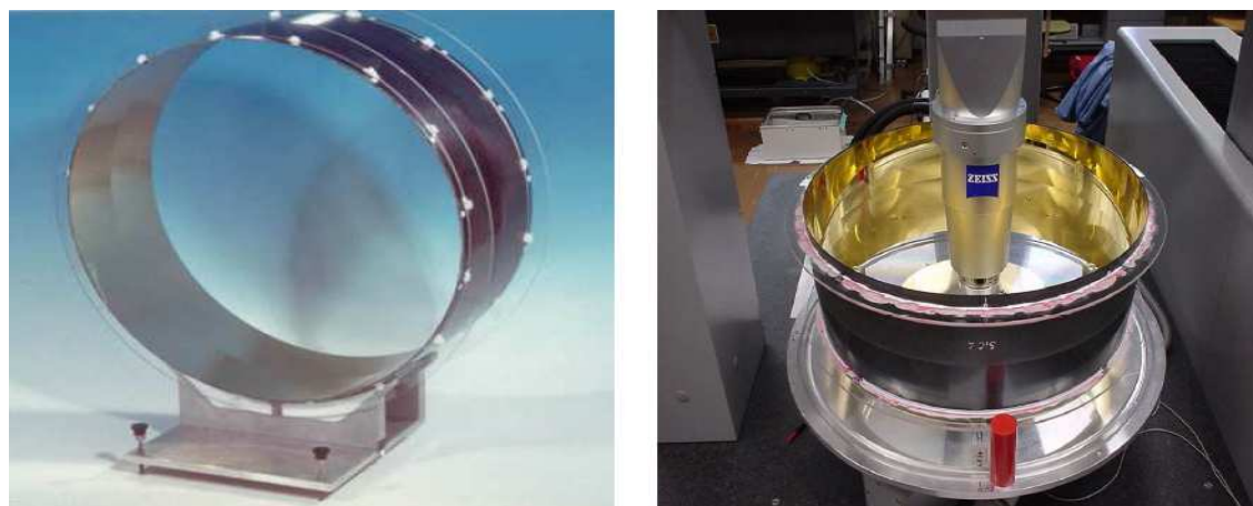
Figura 2.25: Prototipo di ottica realizzata per replica con substrato in Carburo di Silicio.
