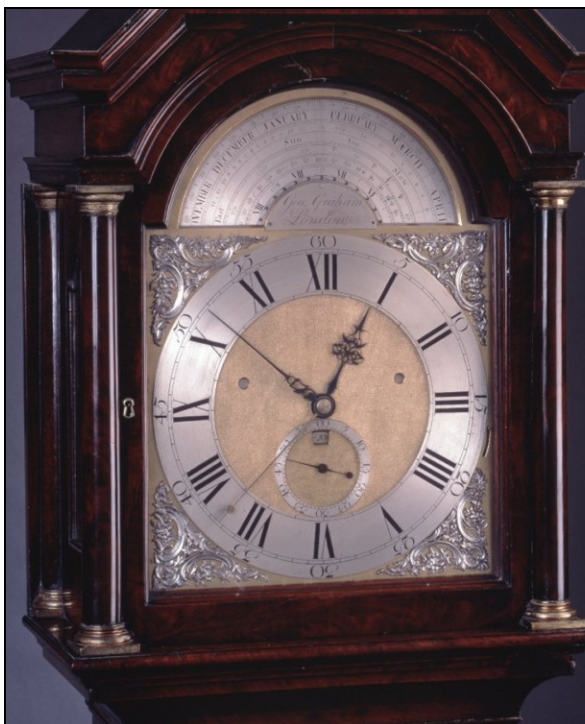
Pendolo con doppia lancetta (tempo solare medio e vero) e indicazioni della data e di altre informazioni astronomiche (George Graham, circa 1740)
