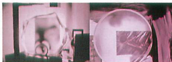
FIG. 2. Struttura interna (evidenziata dalle immagini in birifrangenza) della parte centrale dello specchio Schaer dopo la rottura (sinistra) e, per confronto, di uno specchio in vetro da 50 cm di diametro (destra). In entrambi i casi è evidente la presenza di disomogeneità nei blank, le quali appaiono tuttavia molto più evidenti per lo specchio Schaer che non nello specchio di confronto, realizzato alcuni decenni più tardi usufruendo di tecniche più avanzate nella fusione e raffreddamento dei blank di vetro.
