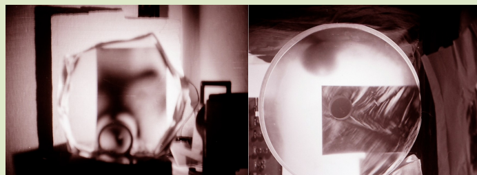
Struttura interna di parte dello specchio Schaer dopo la rottura (sx) e, per confronto, di uno specchio in vetro integro (dx). In entrambi i casi è evidente la presenza di disomogeneità e "striature".
