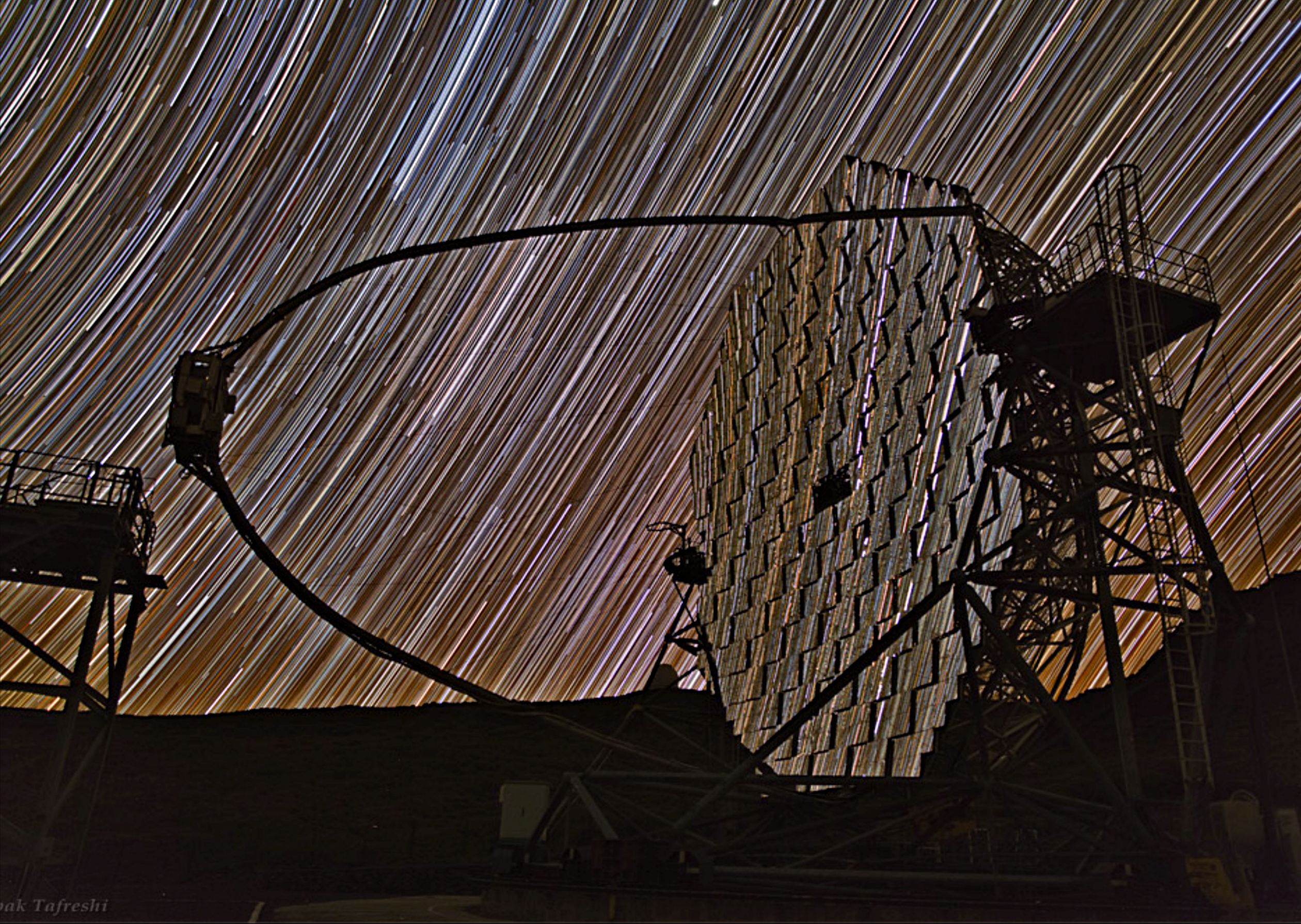
Suggestiva immagine del telescopio Cherenkov MAGIC II, situato sul vulcano Taburiente alle Canarie. Ha un diametro di 17 metri ed è composto da 236 specchi. Parte degli specchi, realizzati con una tecnica innovativa chiamata "cold slumping", è stata realizzata da OAB.
