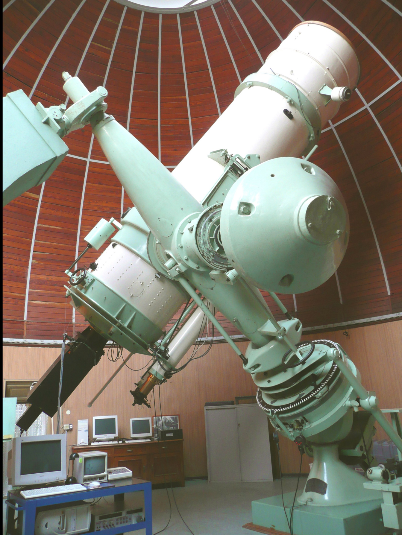
A sinistra: il telescopio Zeiss di OAB con la speckle-camera PISCO. A destra: osservazioni della stella doppia Zeta Aqr. Dall'alto: lo spettro di potenza ottenuto con PISCO, l'autocorrelazione che mostra la presenza di due stelle, e l'orbita calcolata a Merate, perturbata da una terza stella non visibile.
