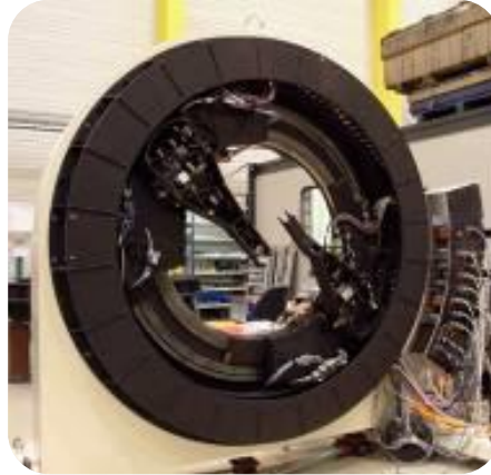
Adapter/Rotator for VLT (ESO)
